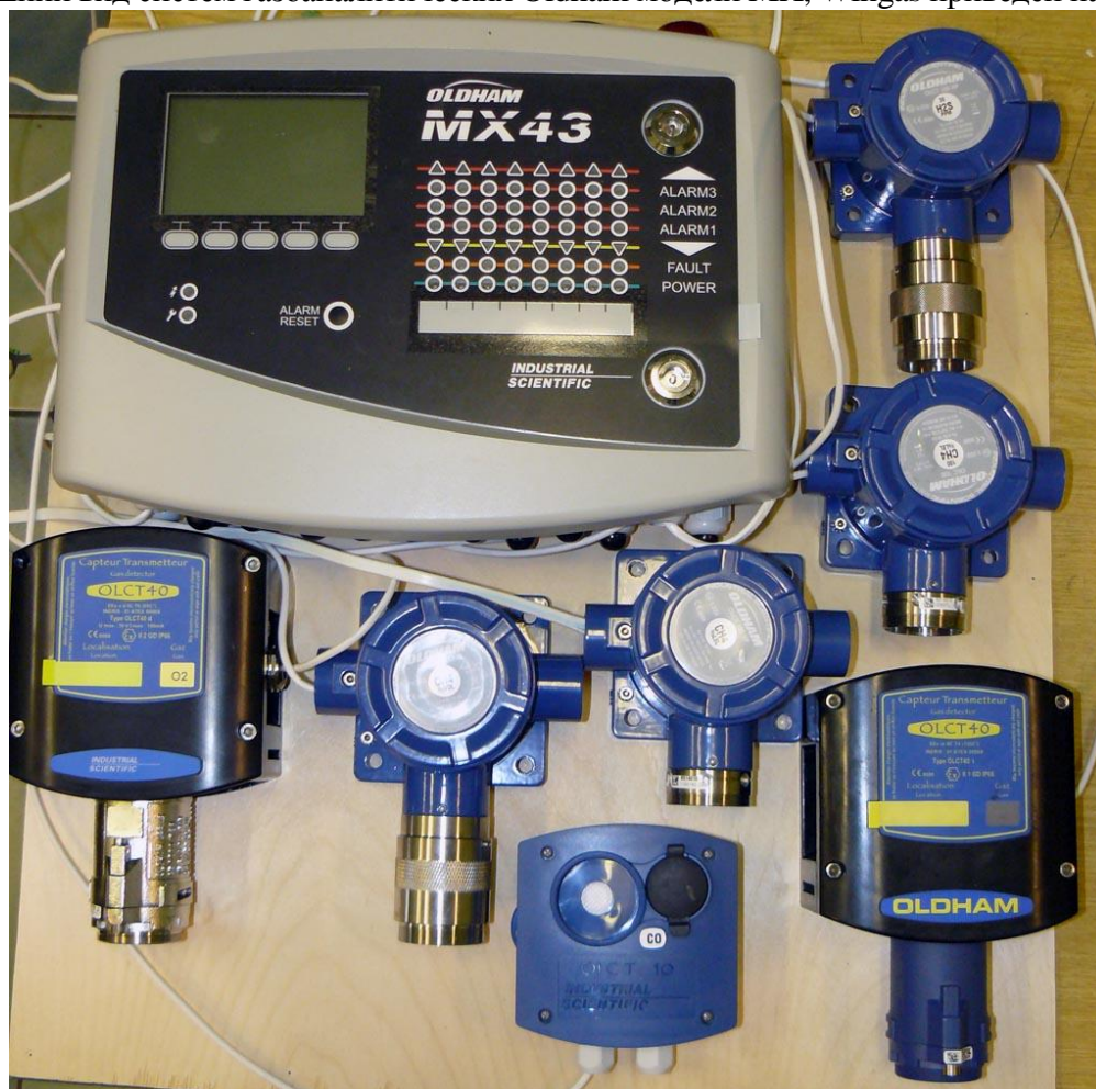
Рисунок 1 – Внешний вид системы газоаналитической Oldham модели MX, Wingas в составе датчиков горючих и вредных газов Oldham моделей OLC 100, OLCT 10, OLCT 40, OLCT 100 XP, OLCT 100 XP IR и ЦБУ MX 43
