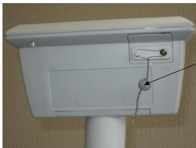
Рисунок 2 - Схема пломбировки весов
