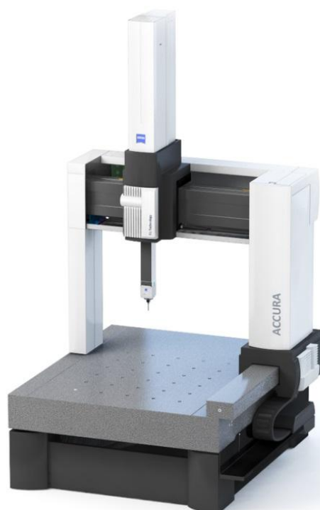
Рисунок 2 - Общий вид КИМ без пыле-влажностной защиты
