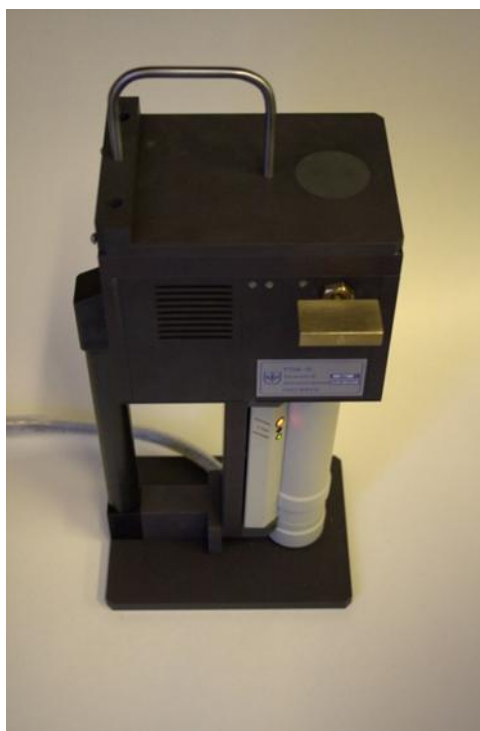
Рисунок 1 - Общий вид толщиномера покрытий ренгенофлуоресцентного РТВК-1К
