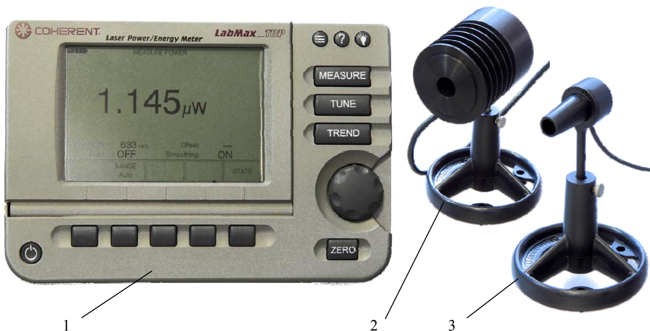
Рисунок 1 - Общий вид ваттметра оптического LabMax-TOP 1 - блок регистрации; 2 – сенсор LM-10 HTD; 3 - сенсор LM-2 VIS.
