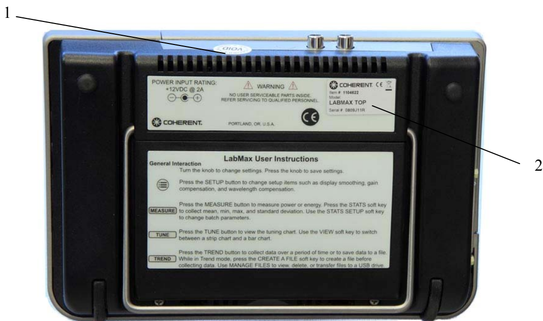
Рисунок 2 – Схема маркировки блока регистрации ваттметра (вид снизу)
