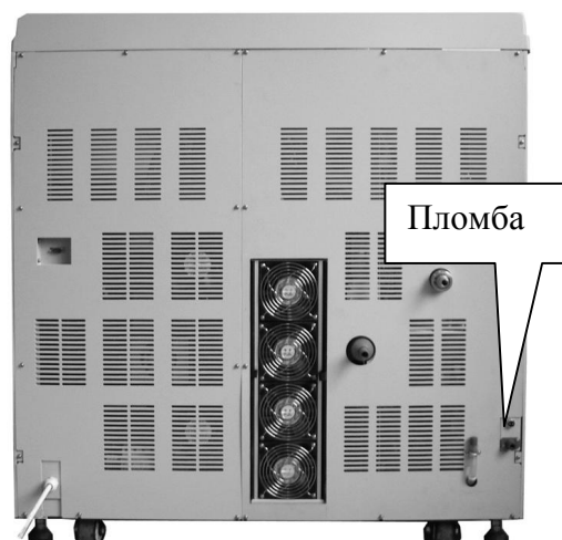
Рисунок 4 - Анализатор биохимический модели Dirui CS-240. Расположение пломбы
