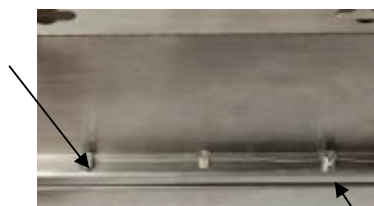
Рисунок 3 - Пример пломбировки корпуса терминалов
