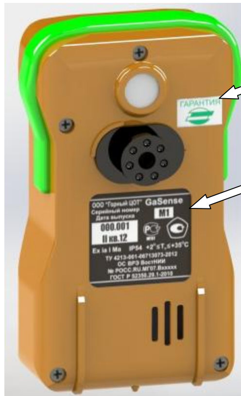
Рисунок 2 - Схема пломбировки корпуса прибора от несанкционированного доступа
