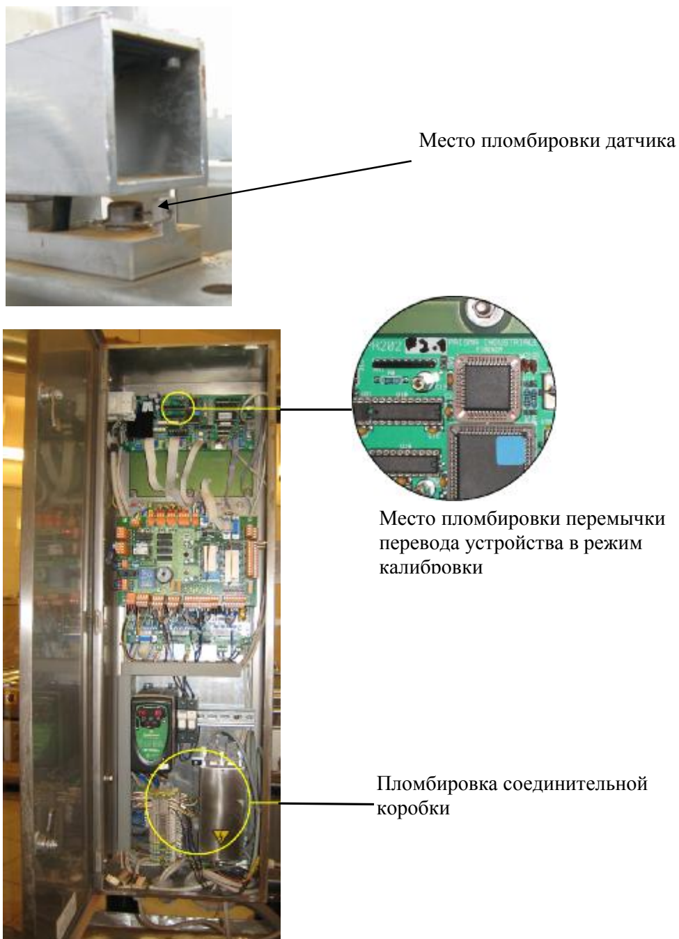
Рисунок 2 — Схема пломбировки от несанкционированного доступа
