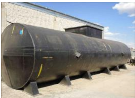
Рисунок 1 Резервуар стальной одностенный РГСО-25
