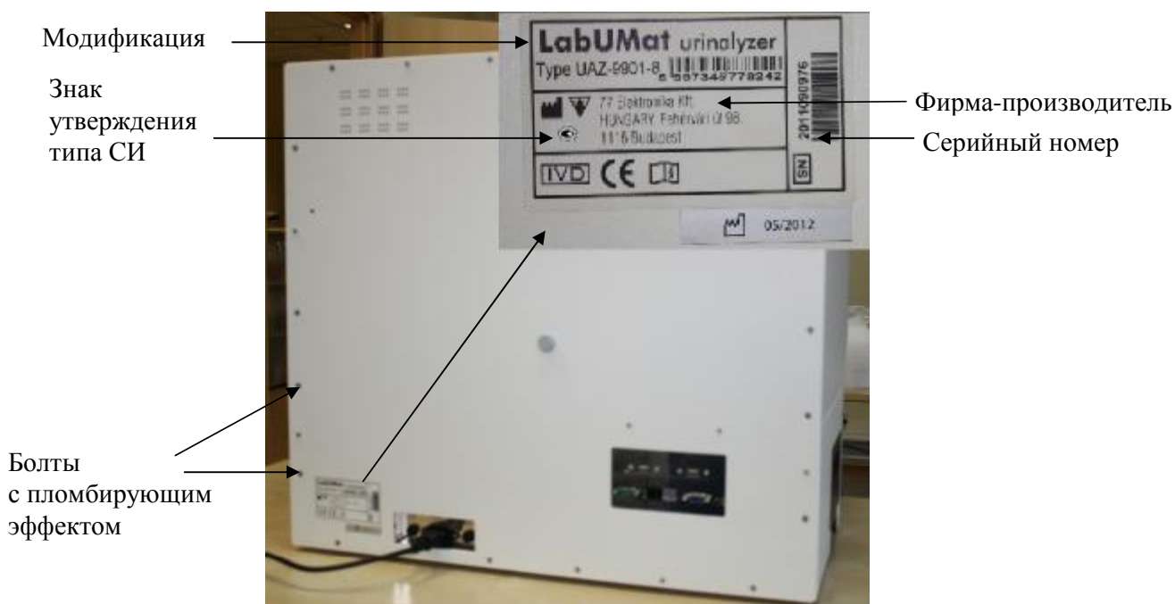
Рисунок 3 – Схема маркировки и пломбировки анализаторов
