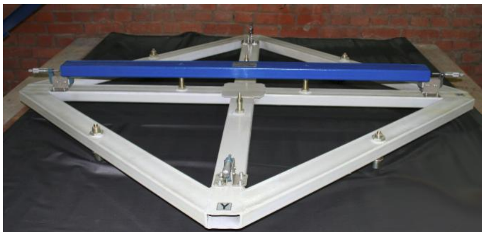
Рисунок 3 – Приспособление для поверки и юстировки с установленным калибром
