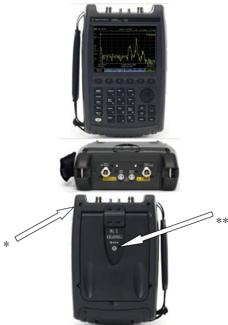
Рисунок 1 - Анализатор с разъемами N - типа по ГОСТ 13317 – 89
