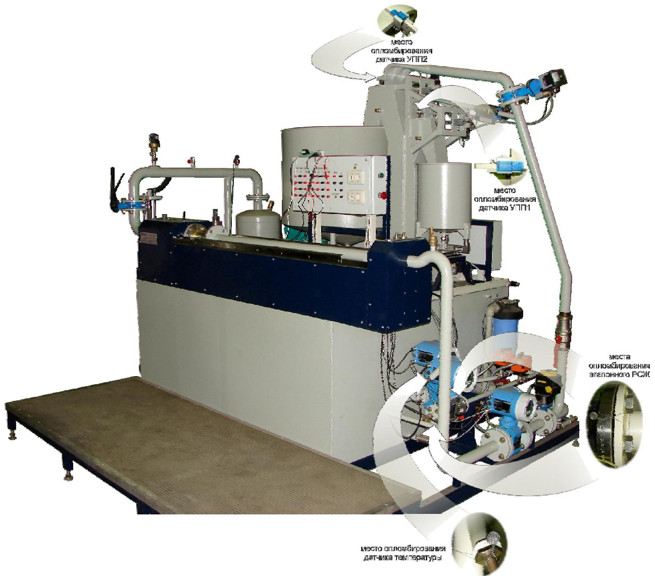
Рисунок 1 – Общий вид УПСЖМ 50 (с местами опломбирования оптодатчиков положения перегородок УПП1, УПП2, эталонных РСЖ, датчика температуры)
