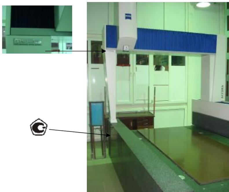
Рисунок 1 - Внешний вид координатной измерительной машины и место нанесения знака утверждения типа
