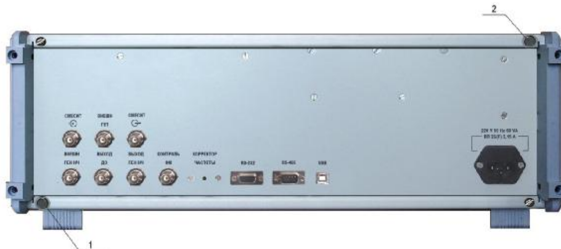
Рис. 2 Схема пломбировки установки.
