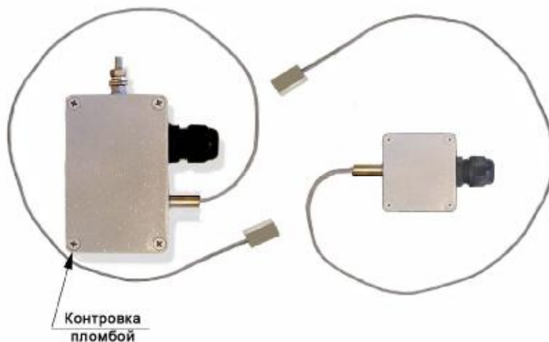
Рис.6 Поверхностные общепромышленные преобразователи ТХА 002.П-Оп, ТХК 002.П-Оп и поверхностные преобразователи ТХА 002.П-Ехi, ТХК 002.П-Ехi с видом взрывозащиты «Искробезопасная электрическая цепь» по ТР ТС 012/2011
