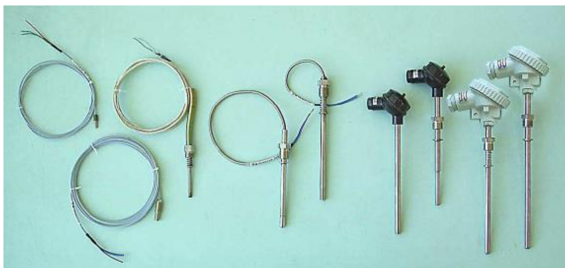
Рис.3 Погружаемые общепромышленные преобразователи ТХА 002-Op, ТХК 002-Op и погружаемые преобразователи ТХА 002-Exi, ТХК 002-Exi с видом взрывозащиты «Искробезопасная электрическая цепь» по ТР ТС 012/2011 с диаметром защитной арматуры до 10 мм включительно
