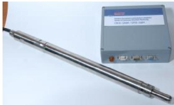
Рисунок 2 – Манометр-термометр
