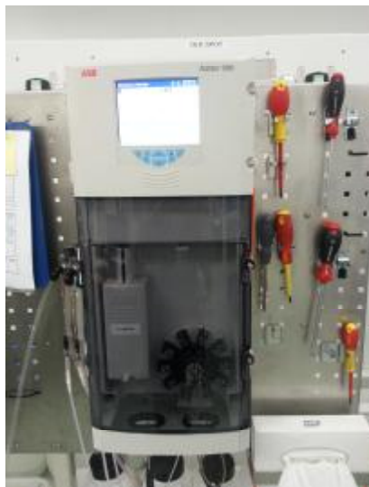
Рис. 2. Общий вид анализаторов воды Aztec 600 с колориметрическим датчиком.
