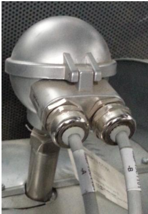
Рис. 1. Внешний вид термопреобразователя сопротивления платинового модели DB812.1.
