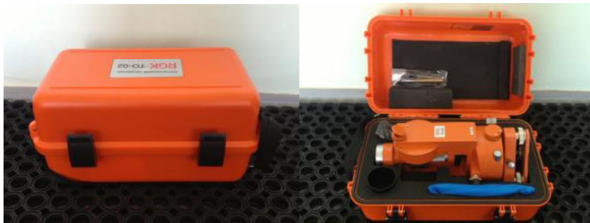
Рисунок 4 - Внешний вид размещения теодолита в футляре
