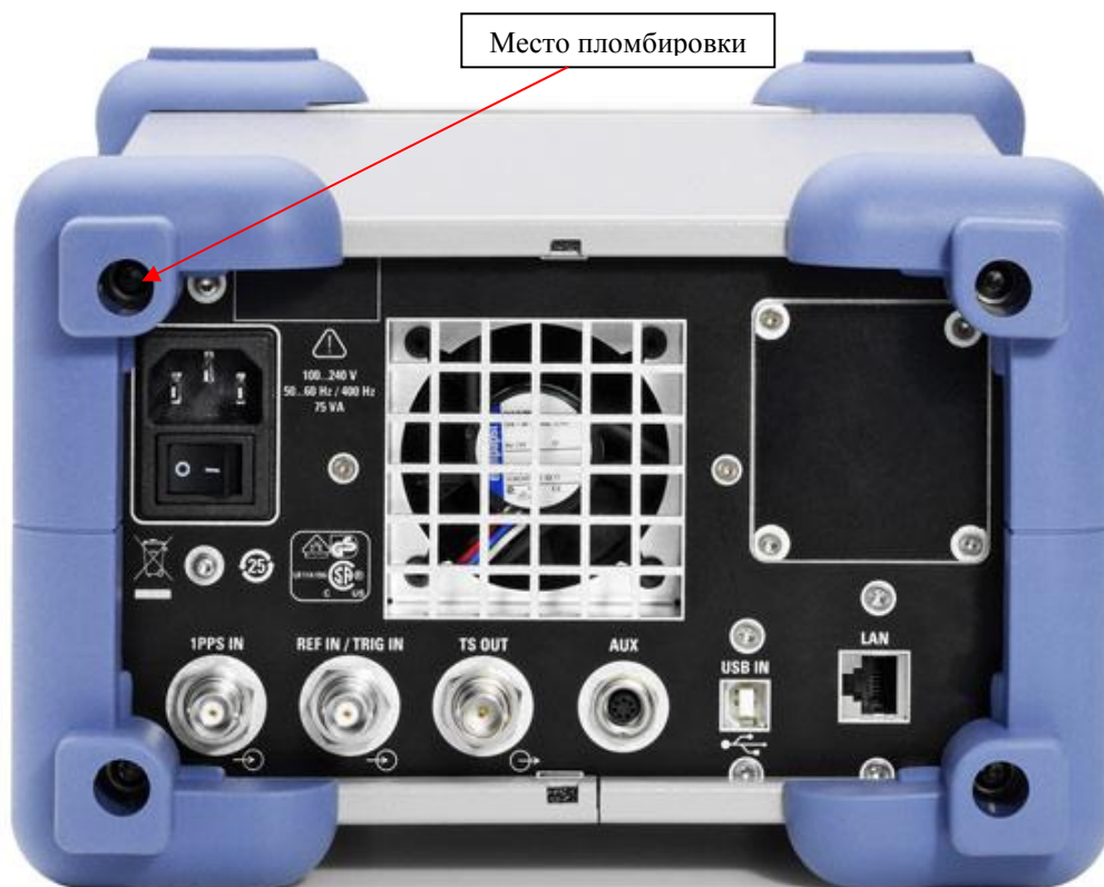
Рисунок 2 - Схема пломбировки от несанкционированного доступа
