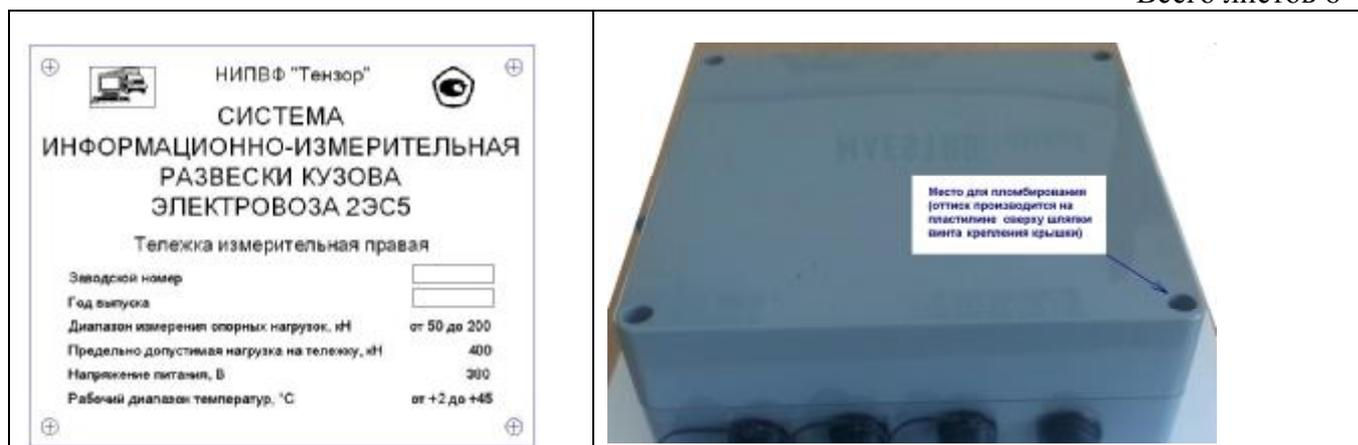
Рисунок 3 – Табличка Системы и схема пломбирования
