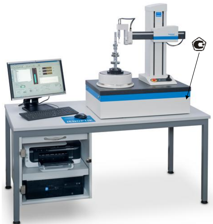
Рис. 2 Общий вид приборов для измерений отклонений формы и расположения поверхностей моделей Hommel-Etamic F135, F155, F435, F455 и место нанесения знака утверждения типа.
