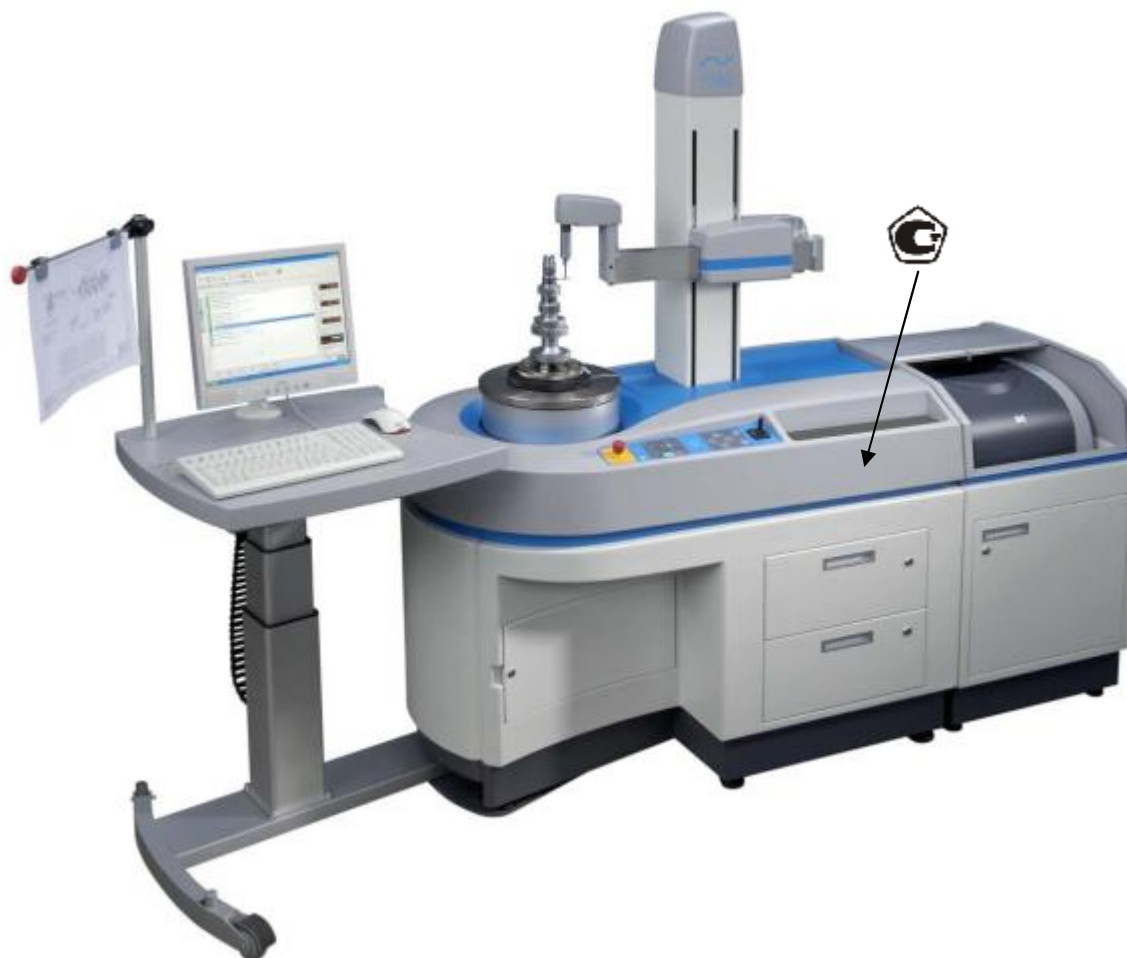
Рисунок 3 – Общий вид приборов для измерений отклонений формы и расположения поверхностей моделей Roundscan 535, Roundscan 555 и Roundscan 590 и место нанесения знака утверждения типа.
