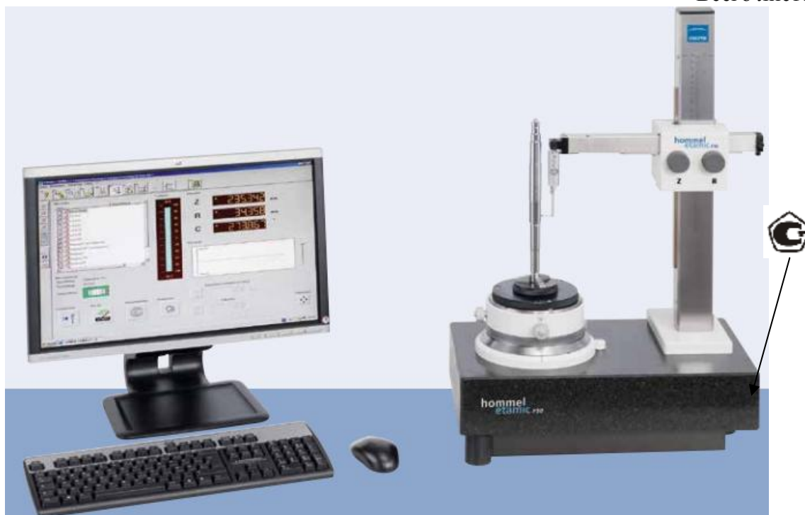
Рис. 1 Общий вид приборов для измерений отклонений формы и расположения поверхностей моделей Hommel-Etamic F50 и место нанесения знака утверждения типа.
