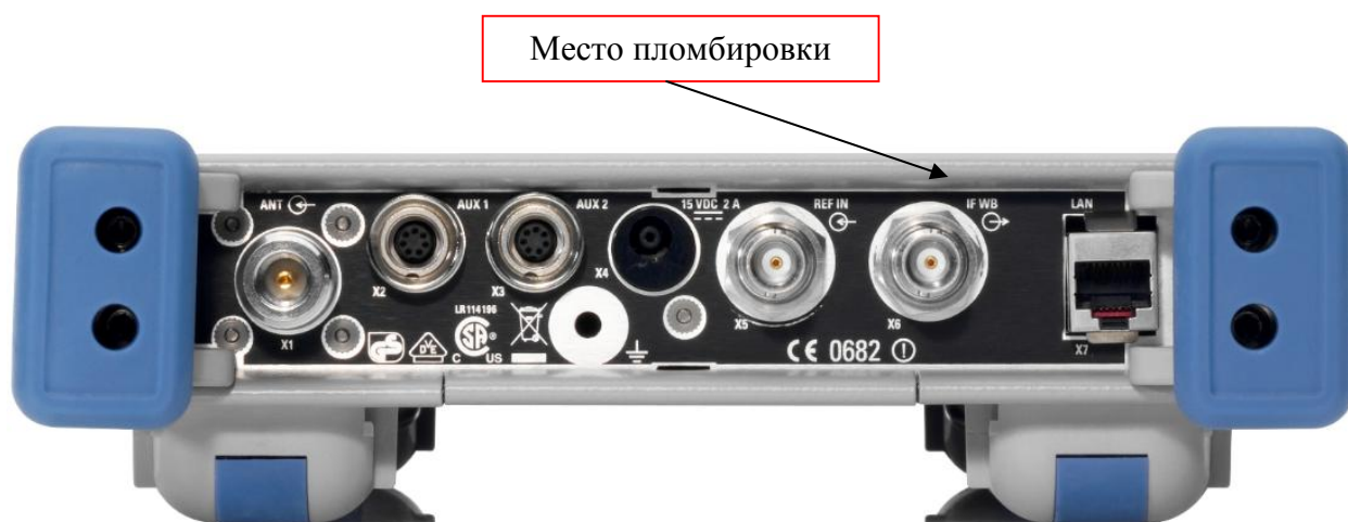
Рисунок 2 - Схема пломбировки от несанкционированного доступа
