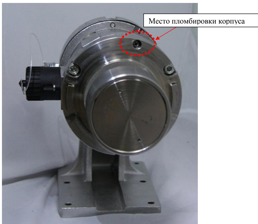
Рисунок 3 – Место пломбировки корпуса газоанализатора для ограничения доступа (на примере СГОЭС-М)
