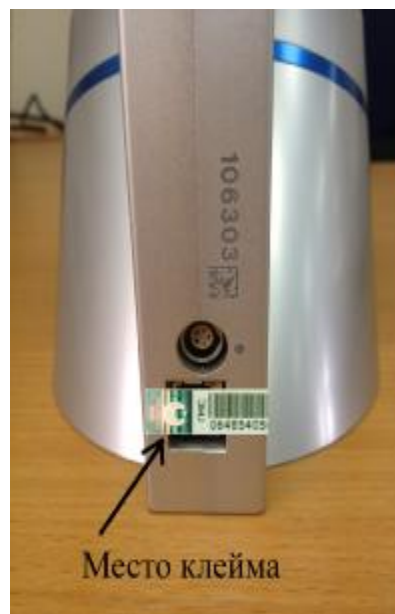
Рисунок 2 – Место клеймения: знак поверки в виде наклейки наклеивается на разъем USB
