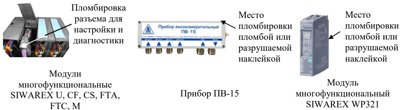
Рисунок 2 - Схемы пломбировки от несанкционированного доступа УОАД
