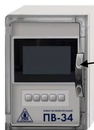
Рисунок 4 - Схемы пломбировки от несанкционированного доступа приборов
