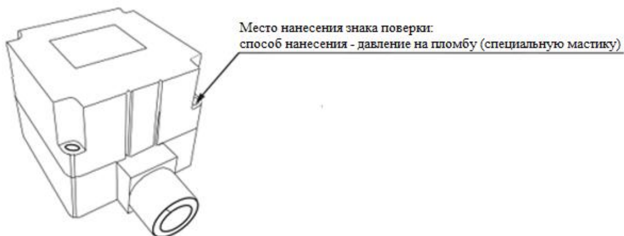
Рисунок 2 – Схема пломбировки от несанкционированного доступа, обозначение места нанесения знака поверки
