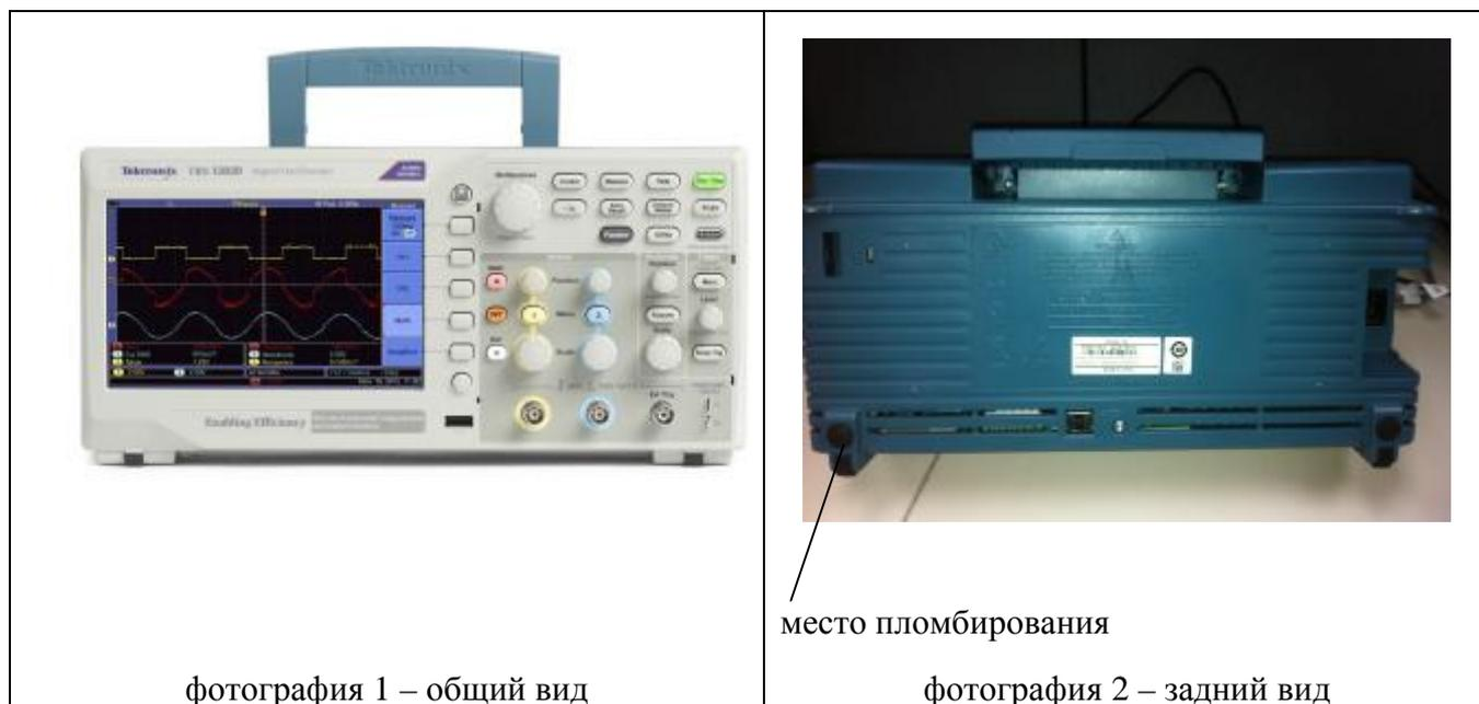
По условиям эксплуатации осциллографы цифровые серии TBS1000B соответствуют группе 3 ГОСТ 22261-94 с рабочим диапазоном температур от 0 до 50 °С.
