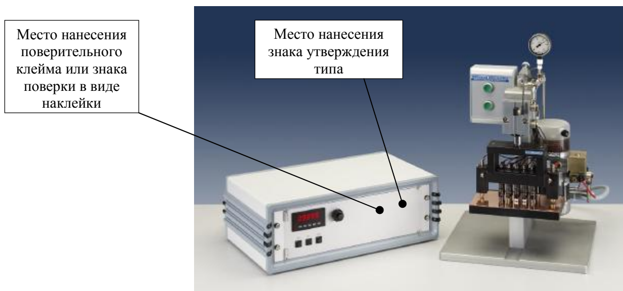
Рисунок 1 – Общий вид тестера Франклина
