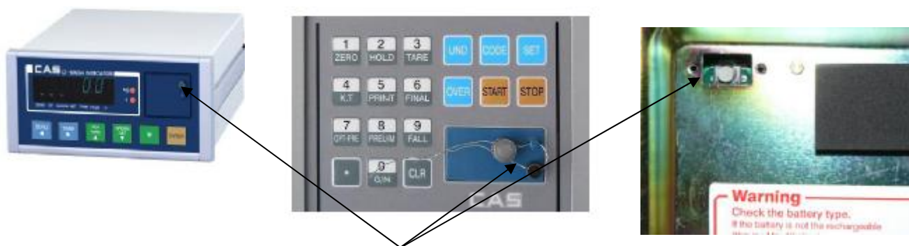
Схема пломбировки весов, в случае установки индикаторов в защитный ящик
