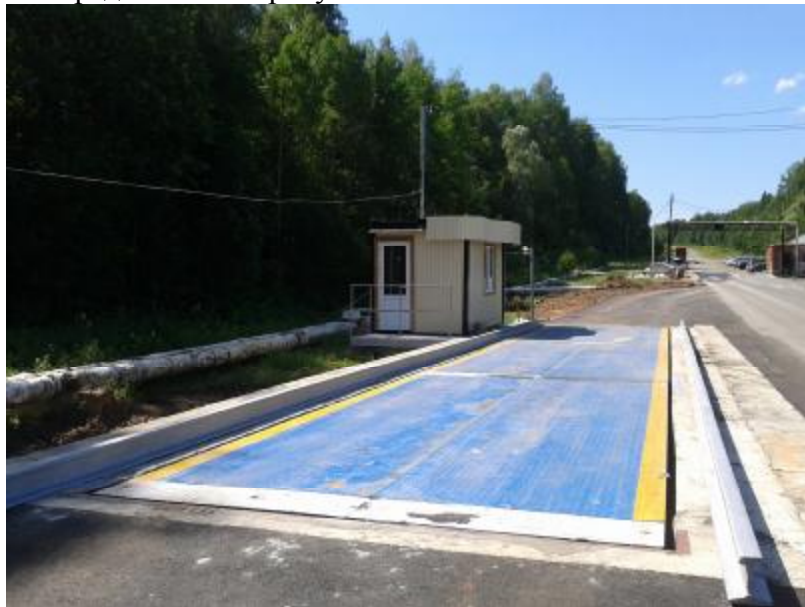
Рисунок 1 – Общий вид весов автомобильных Штрих МВА.
