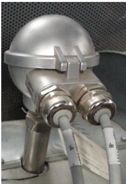
Рис. 1. Внешний вид термопреобразователя сопротивления платинового модели DB812.20.
