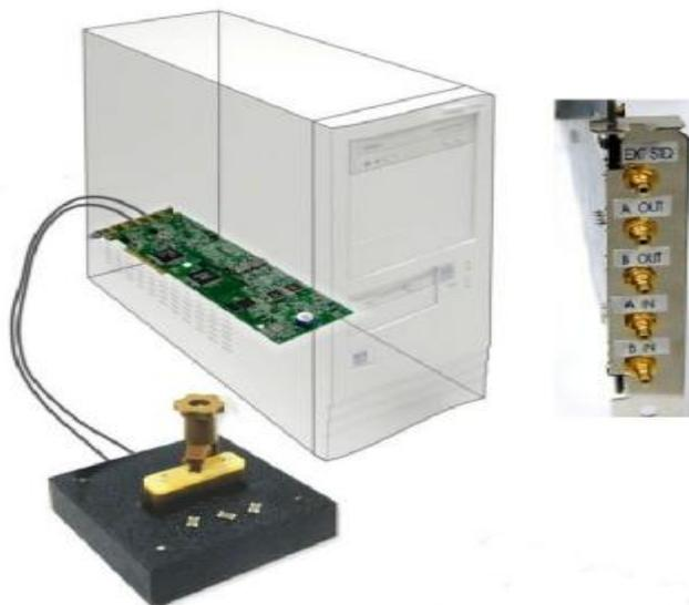
Рисунок 1 - Внешний вид анализатора
