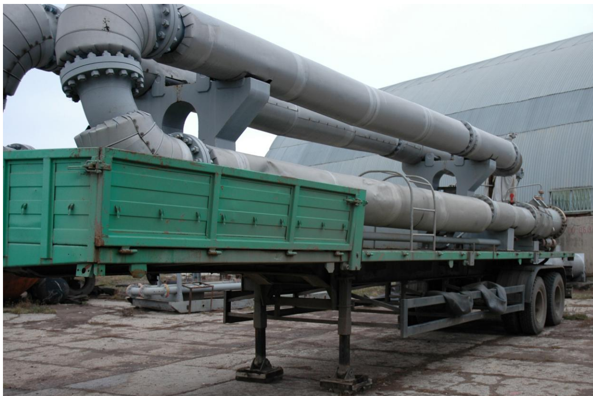
Рисунок 1 - Общий вид установки трубопоршневой двунаправленной ВНР-550
