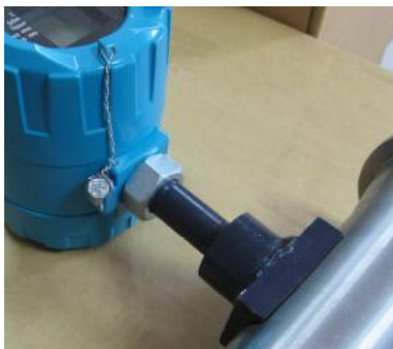
Рис.2. Схема пломбировки расходомера-счетчика ЭРВИП.НТ
