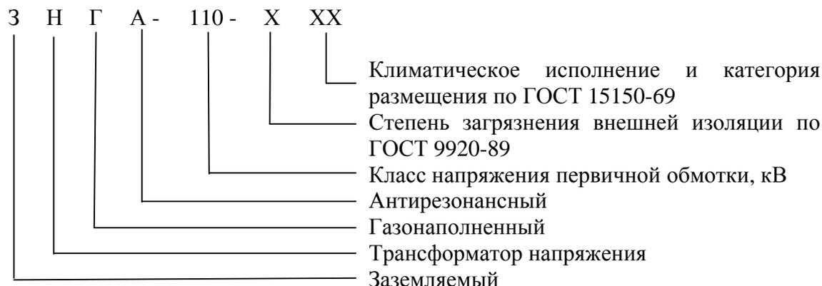
Пример записи обозначения трансформатора:
