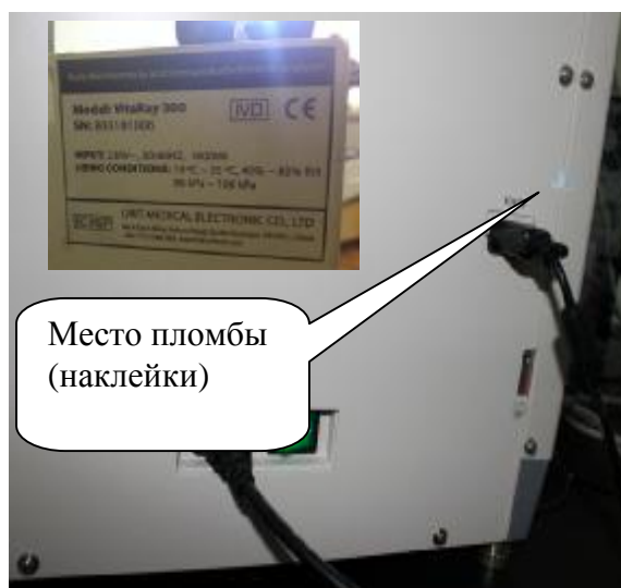
Рисунок 2 – Расположение пломбы (наклейки) Анализатор автоматический биохимический модель VitaRay-300.
