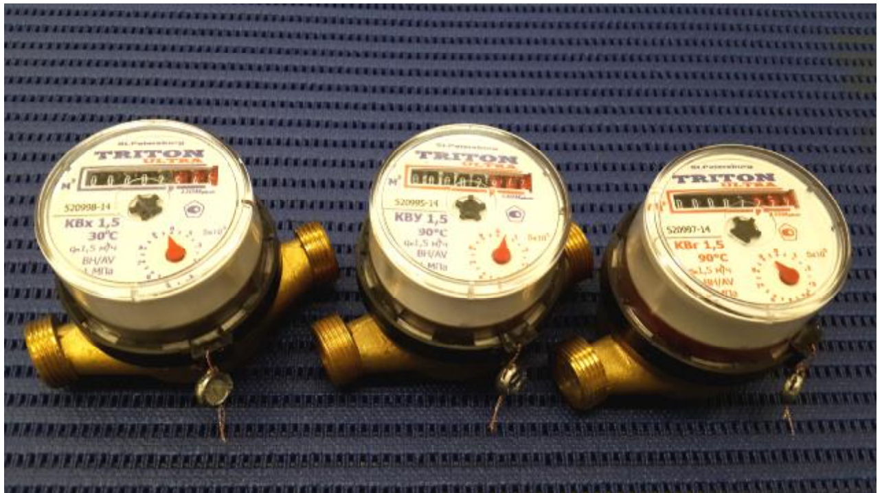
Рисунок 1 – Счётчики холодной и горячей воды крыльчатые «ТРИТОН-УЛЬТРА» («TRITON-ULTRA»)
