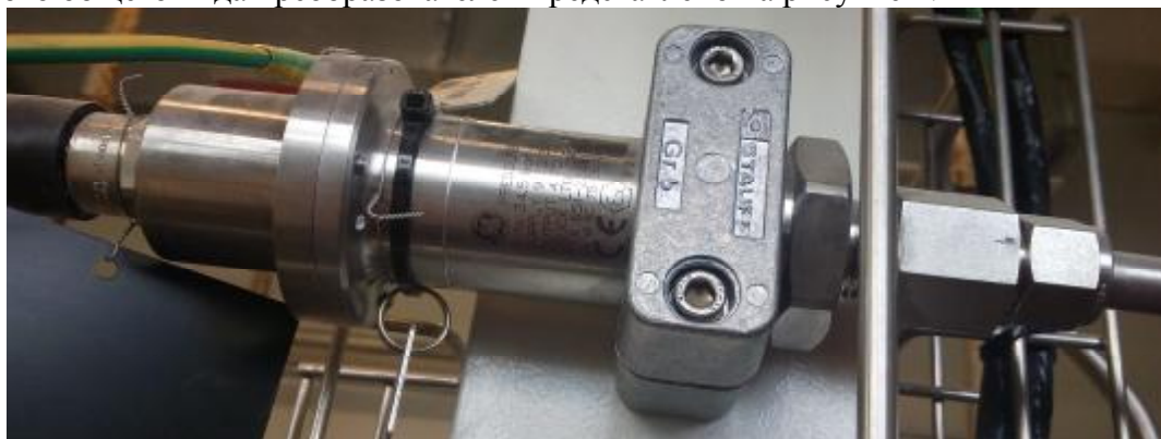
Рис. 1 Преобразователь давления измерительный РТХ 651-2348.
