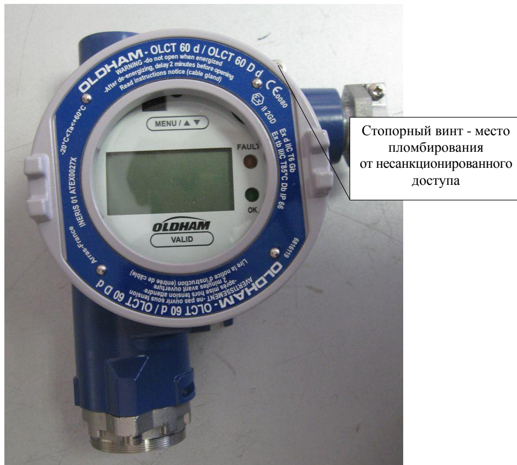
Рисунок 2 - Схема пломбирования датчиков
