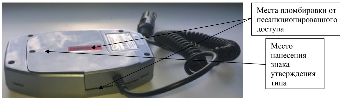
Рисунок 2 – Схема пломбировки от несанкционированного доступа и место нанесения знака об утверждении типа
