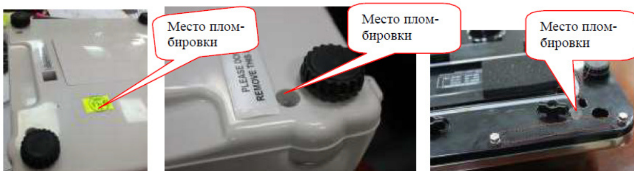
Рисунок 6 - Место пломбировки от несанкционированного доступа весов CS2010
