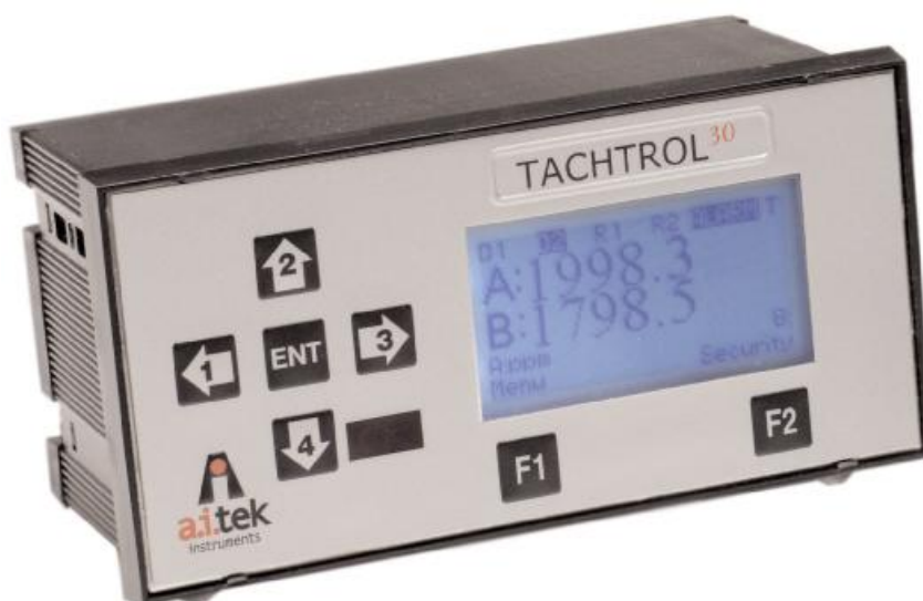
Рисунок 1 - Общий вид тахометра электронного Т77630-40
