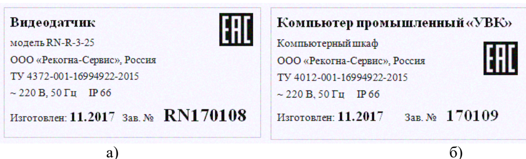
Рисунок 1 – Пример маркировки: а) видеодатчика комплексов; б) компьютерного блока
