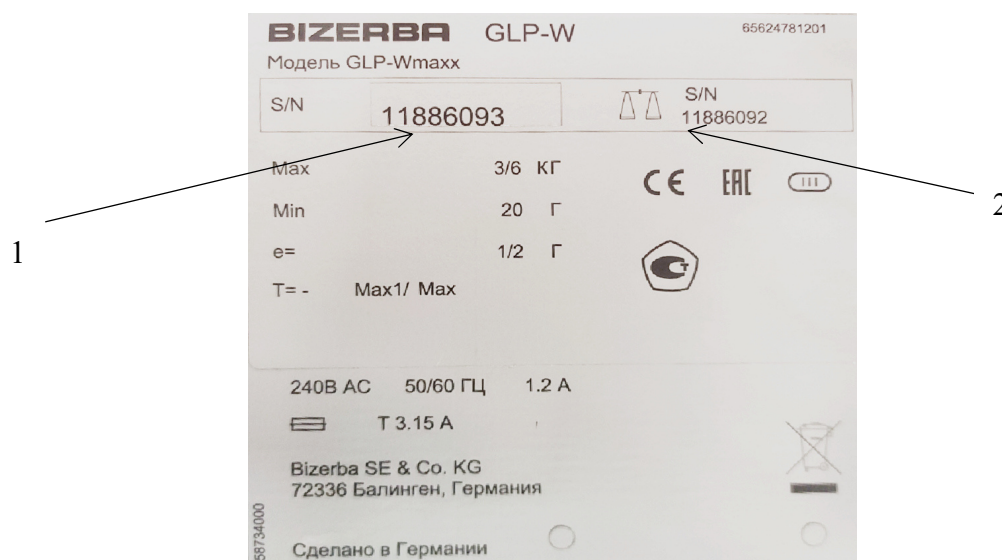
Рисунок 5 — Общий вид маркировочной таблички (пример) (1 — заводской (серийный) номер весов / 2 – заводской (серийный) номер ГПУ)
