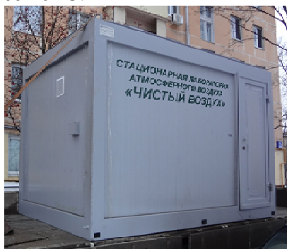
Рисунок 1 – общий вид стационарной станции контроля загрязнения атмосферного воздуха автоматической ЧИСТЫЙ ВОЗДУХ
