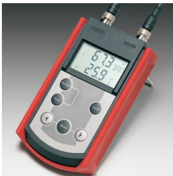
Рисунок 1 - Внешний вид регистраторов данных портативных HMG 500, HMG 510
