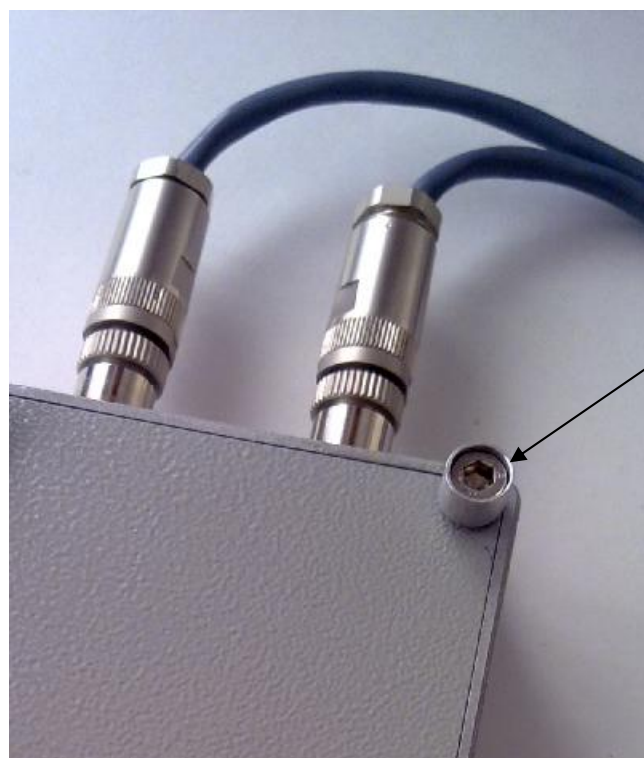
Рисунок 3 - Вид отсека печатной платы измерителей сопротивления изоляции МИС100 с указанием места установки мастичной пломбы
